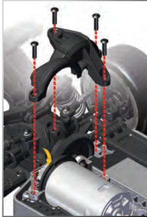
Para ajustar la rueda dentada, use el cuadro de la izquierda para identificar las posiciones del tornillo en la placa del motor (A - K) que corresponden con el tamaño del engranaje de piñón del motor elegido. Extraiga los dos tornillos del motor o la placa del motor y vuelva a instalar en las posiciones correspondientes. Vuelva a instalar el motor o ensamblaje de la placa del motor en el chasis.
