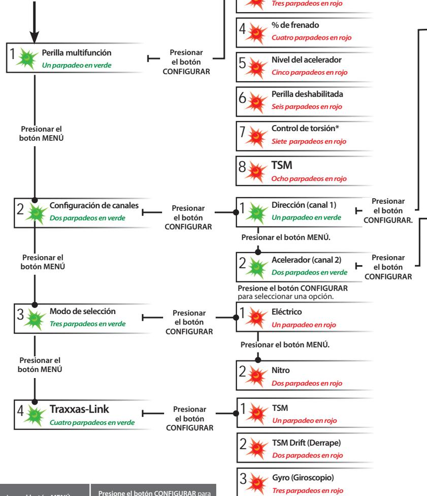
Nota: El transmisor está encendido durante la programación, de manera que puede probar la configuración en tiempo real sin necesidad de salir del árbol de menú.
