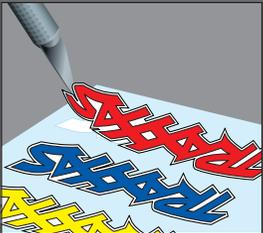
Para aplicar las calcomanías, coloque un extremo hacia abajo, sostenga el otro extremo arriba y deslice el dedo lentamente a medida que avanza. Esto evitará que se formen burbujas de aire. Si coloca los dos extremos de la calcomanía hacia abajo y luego intenta deslizar el dedo, se producirán burbujas de aire. Observe las imágenes en el recuadro para ver una típica colocación de calcomanías.
